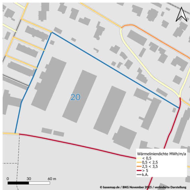
Wärmelinienichte (Indikator für Wärmenetz)
