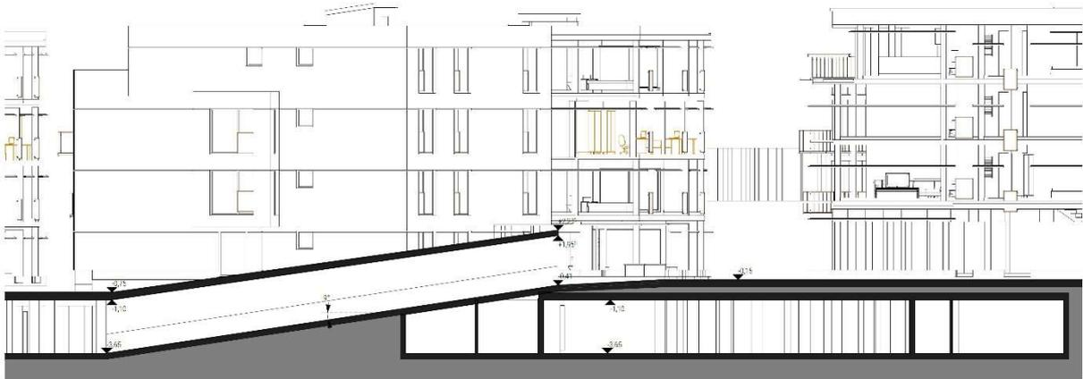
Abb. 5: Längsschnitt TG-Rampe für „Postareal“ vom 23.02.2022 [4], links: Süden, rechts: Norden
