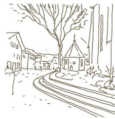
**Stadtboden** | Der vorgeschlagene Stadtboden entwickelt sich aus den vorgefundnen Belägen dem Straßengeviert. Granitgrostein in Bändern von unterschiedlicher Breite erstreckt sich in den Straßenräumen von Fassade zu Fassade. Neben die unterschiedlichen Breiten wird der Belag aus drei verschiedenen Grautönen gemischt. Die Oberflächen sind gesägt und gefammt. Die Kanten sind gebrochen. Der Belag ist - abhängig von Belastungskategorie und Baugrund - dynamisch auf einer Drainschicht verlegt.
