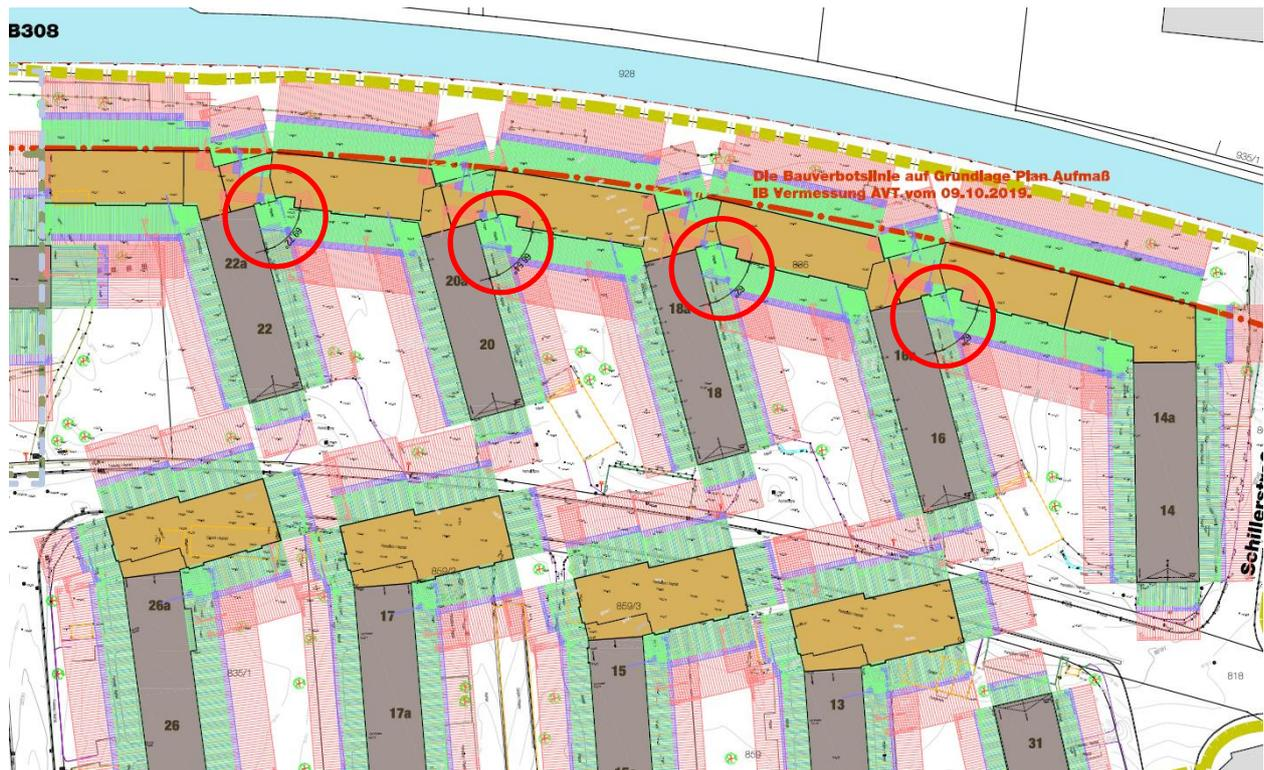
Abbildung 7: Ausschnitt aus dem Abstandsflächenplan, Darstellung der Bereiche, bei denen sich die Abstandsflächen um weniger als  $75^\circ$  überschneiden rot umrandet, Quelle: wolf.sedat Architekten, eigene Bearbeitung
