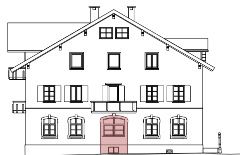
Der ursprünglich mittige Haupteingang wurde auf die Seitenfassade versetzt. Anstelle der Türe trat ein Fenster.
