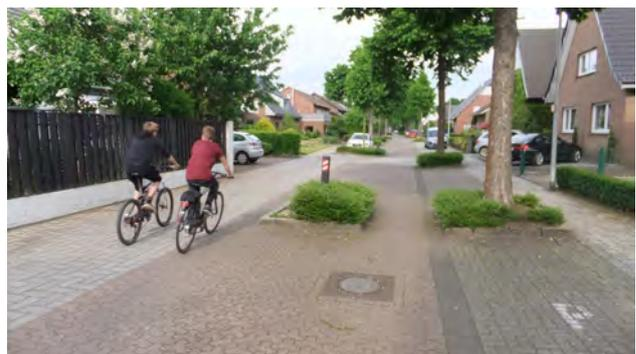
Abb. 19: Oberflächenstruktur und die Anordnung der begrünten Inseln — u.a. in der Fahrbahnmitte — reduzieren die Geschwindigkeiten in diesem verkehrsberuhigten Bereich (VZ 325) spürbar.
