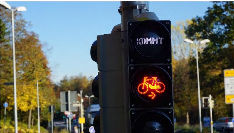
Abb. 94: „Signal kommt“-Anzeige für den Radverkehr
