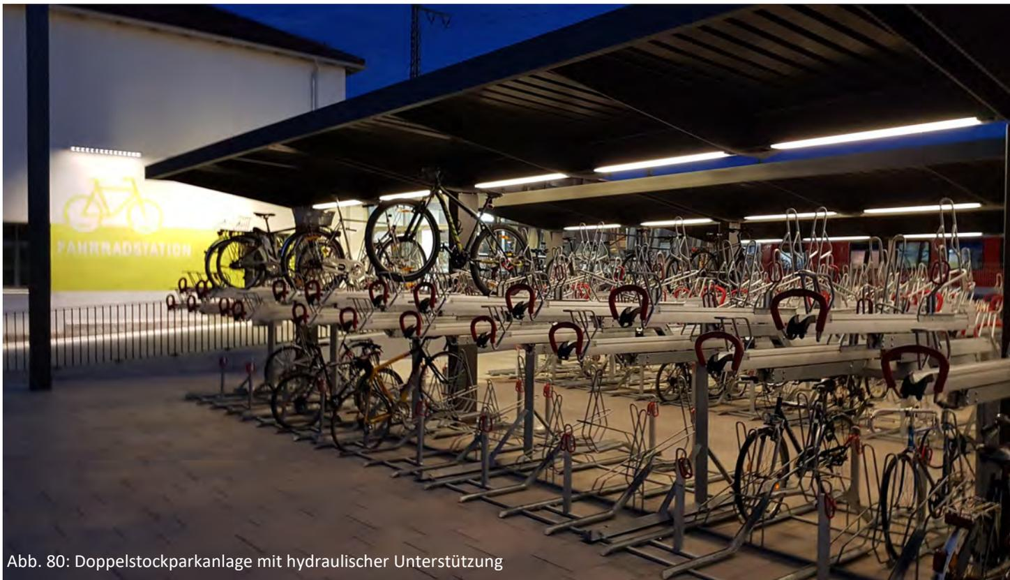
Abb. 80: Doppelstockparkanlage mit hydraulischer Unterstützung
