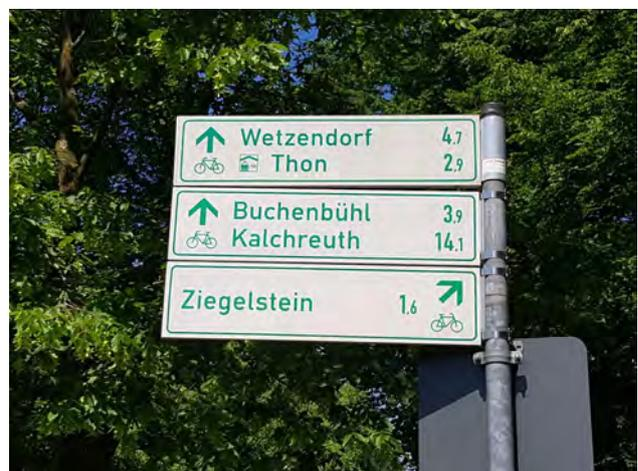
Abb. 72: Mit Tabellenwegweisern nach dem Standard der FGSV können Richtungsinformationen bereits gut sichtbar vor dem Knotenpunkt angebracht werden.
