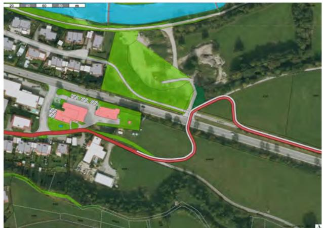
Abb. 52: Planfreie Querung der Bundesstraße mit einem Überführungsbauwerk
