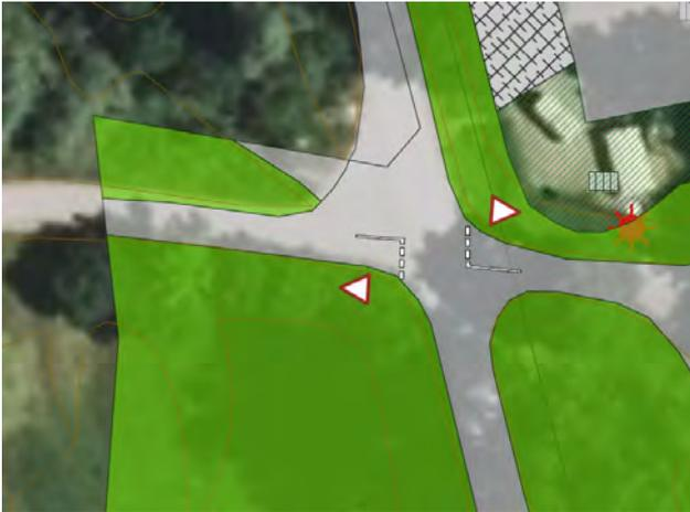
Abb. 49: Vorrangregelung durch verkehrsrechtliche Markierung und Beschilderung
