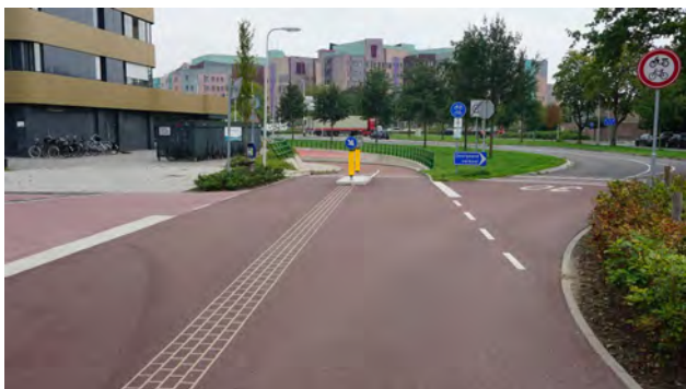
Abb. 25: Intuitive Wegführung für den Radverkehr durch bauliche Gestaltungsmaßnahmen
