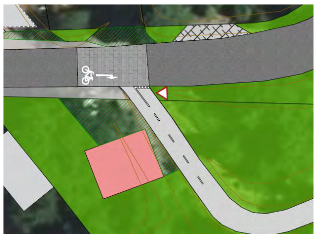
Abb. 48: Sicherung der Einmündung nach Abbau der Umlaufsperrung
