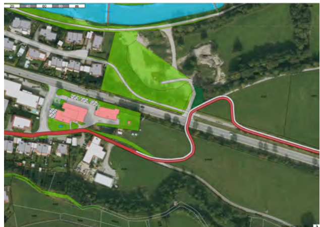
Abb. 52: Planfreie Querung der Bundesstraße mit einem Überführungsbauwerk
