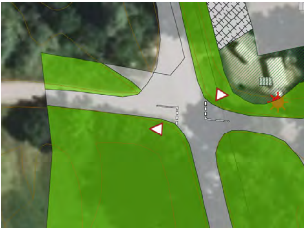
Abb. 49: Vorrangregelung durch verkehrsrechtliche Markierung und Beschilderung
