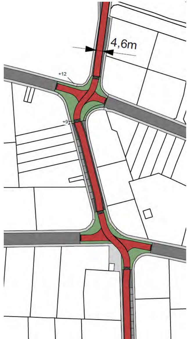
Abb. 58: Konzeptskizze zur Einrichtung einer bevorrechtigten Fahrradstraße mit roter Oberfläche und gut erkennbarer Fahrgasse.
