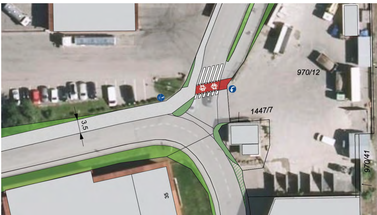
Abb. 44: Konzeptskizze zur zukünftigen Radverkehrsführung im Bereich der Milchwerkunterführung.
