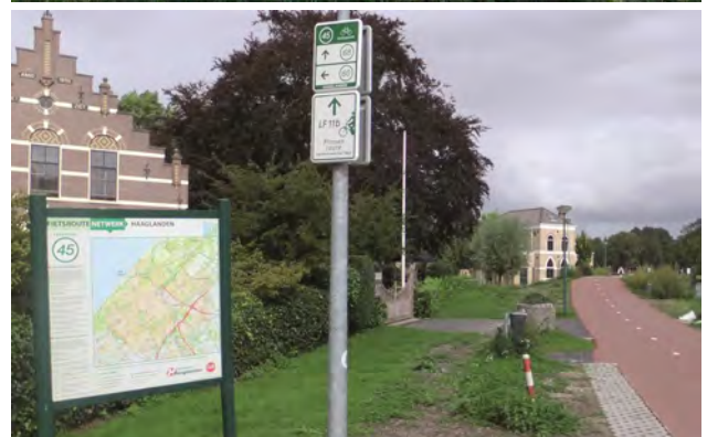
Abb. 74: Ausstattungselemente eines nummerierten Knotenpunkts: Standortnummer, Übersichtstafel mit dem Radverkehrsnetz und Knotenpunkten, Wegweisung zu benachbarten Knotenpunkten
