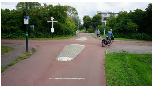
Abb. 50: Aufgepflasterte Mittelsinseln aus den „untergeordneten“ Radwegen
